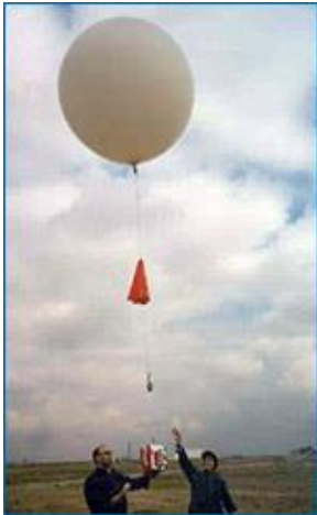
Balões de alta altitude transportam aparelhos de medição sensíveis até à atmosfera superior para verificar os níveis de ozono.
